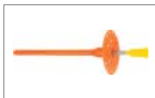
PTH-KZL 60/8 - hmoždinka s ocelovým trnem Ø 8 mm do dutých materiálů
